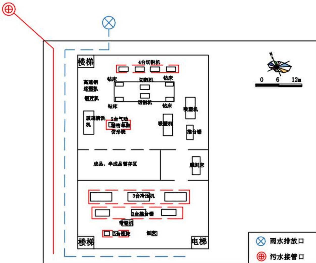
附图 5-1 建设项目总平面布置图（一层）
