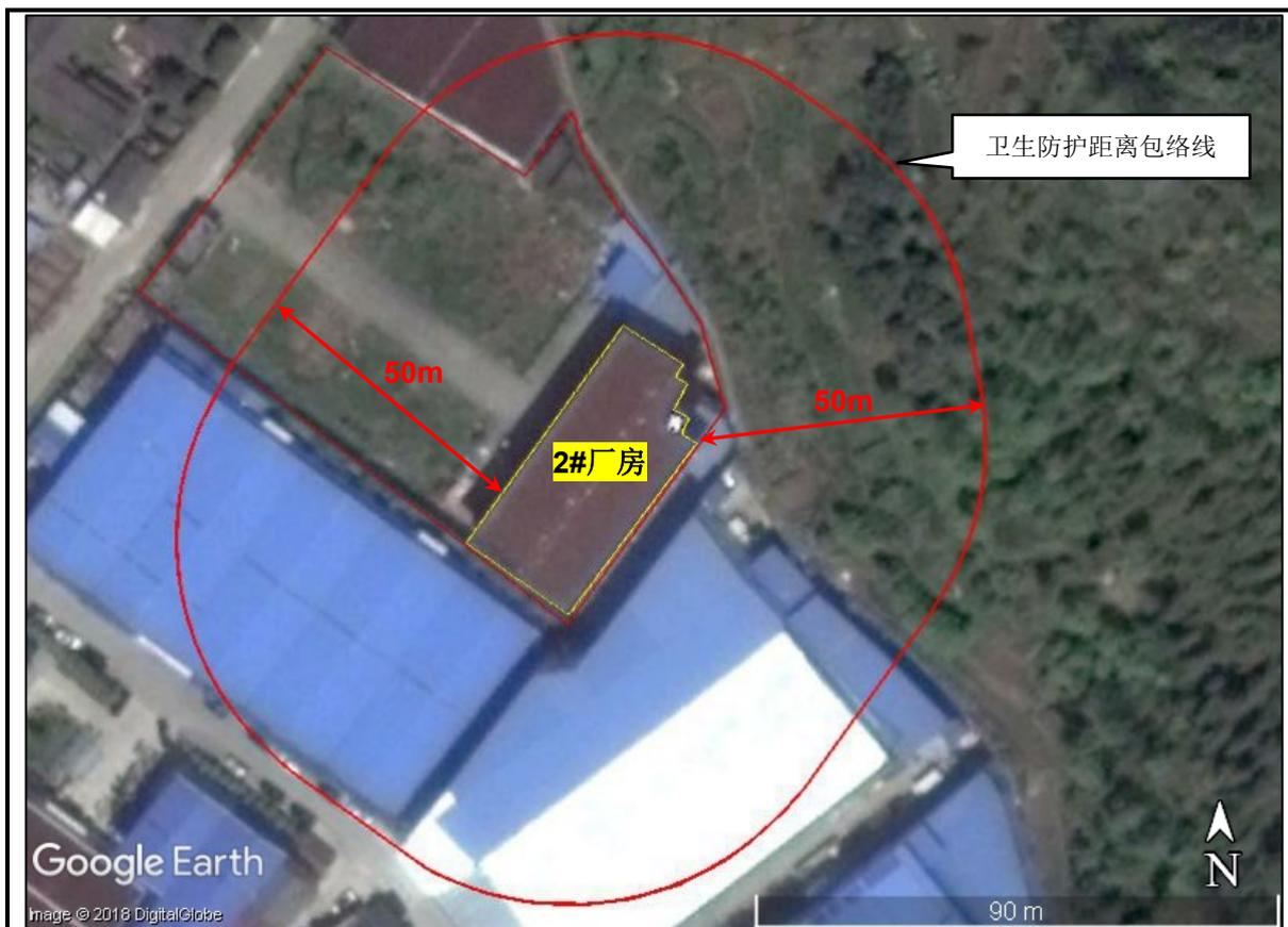
图 7-1 项目生产车间卫生防护距离包络图
