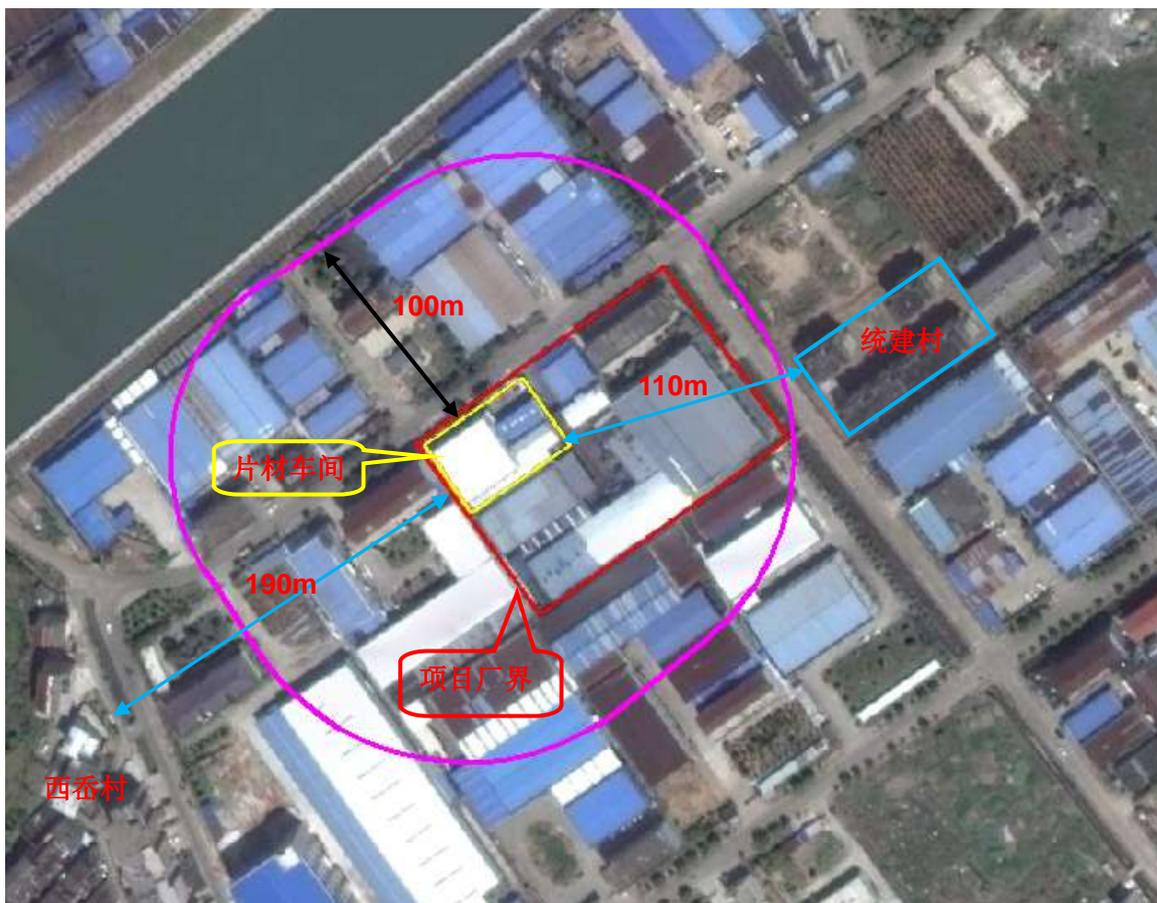
图 7-1 项目卫生防护距离包络线图
